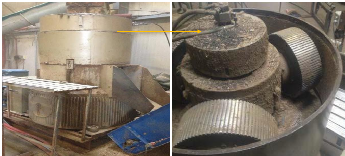
Figure 2 : Exemple de presse à galets- vue intérieure avec galets et filière
