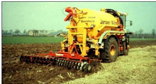
Photo 1 : Matériel d'incorporation combiné à un gros réservoir
