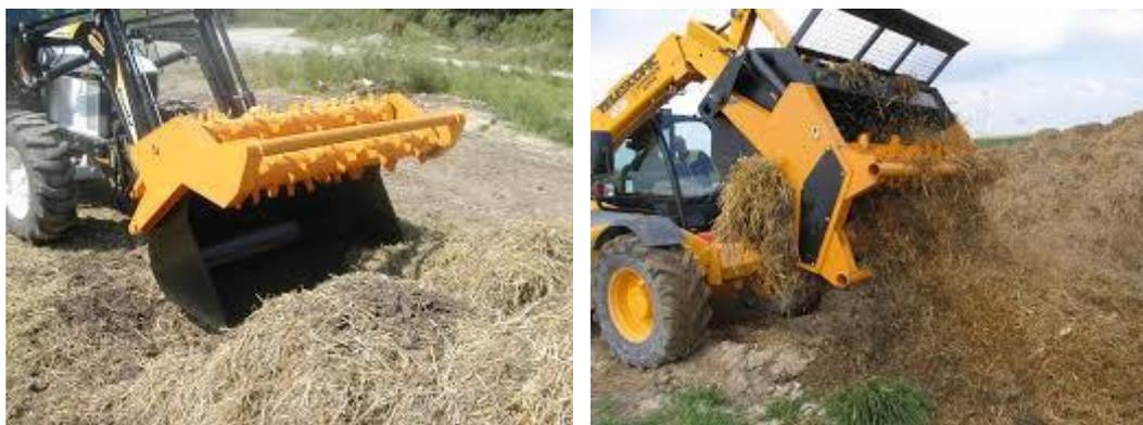
Figure 5 : Exemple de godets aérateurs
