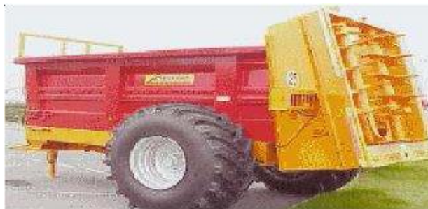
Photo 1 : Epandeur à hérissons verticaux
