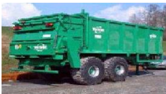
Photo 2 : Epandeur à table d'épandage
