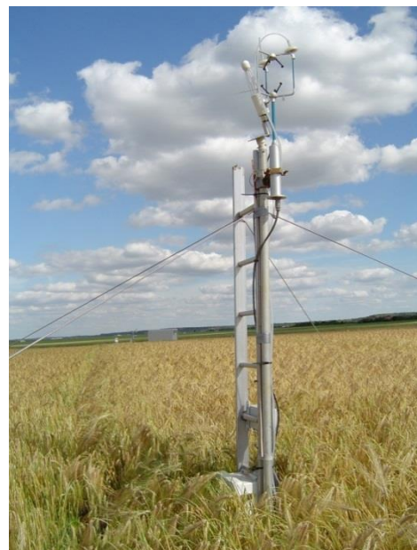
Figure M31.1. Système de mesure de flux de CO 2 par covariance turbulente (source: INRA)
